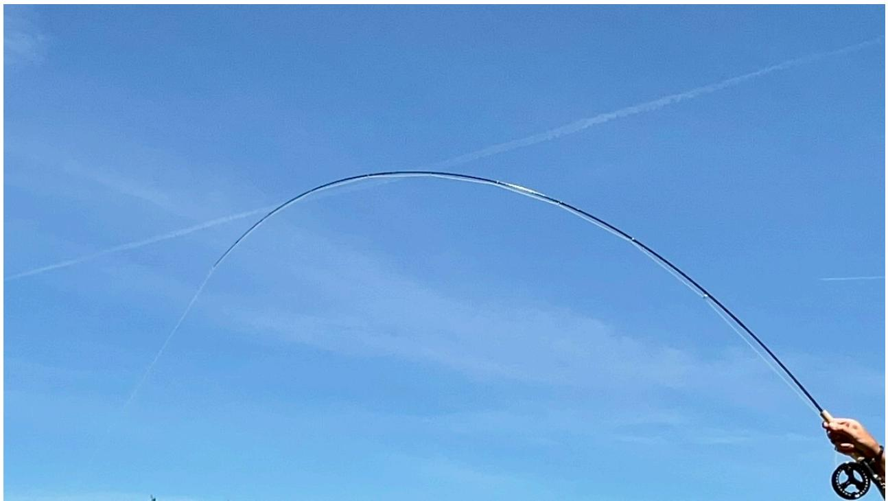
Man sieht auf dem Foto deutlich, dass bei einer Biegungsbelastung der Rute um 90 Grad das komplette Spitzenteil fast „glatt“ gezogen wurde und Rutenteil 3, zwischen Spitze und Teil 2 nach unten, dieser Aktion sanft folgt. Die unteren beiden Rutenteile haben aber genügend Kraft und Steifigkeit, um auch größeren Forellen Paroli zu bieten und der Rute eine angenehme Spritzigkeit verleiht, die beim Fischen mit der Trockenfliege Spaß macht.
